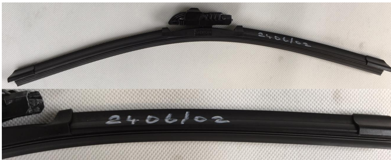
Obrázek č. 5 – vzorek č. 462202406/02 – Sheron Uni Flat 475 mm po 500 000 cyklech
