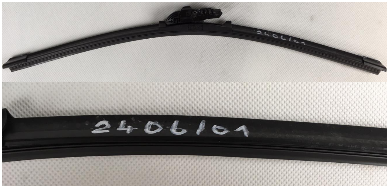
Obrázek č. 4 – vzorek č. 462202406/01 – Sheron Uni Flat 525 mm po 500 000 cyklech
